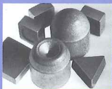
1 用砧座方式制造的典型零件
